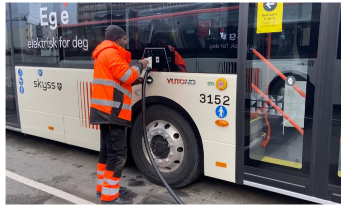
Elektrobus erhält Vorkonditionierung während er angeschlossen ist.
